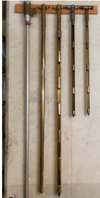
Probenahmegerät: Probenstecher Wird genutzt, um Getreideproben aus Transportmittel (z. B. LKW) oder im Flachlager zu ziehen. Die Länge des Probenahmestabs sollte auf die Tiefe der Erzeugnisse im Fahrzeug/Lager abgestimmt sein.
